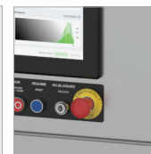
Parada de emergência
